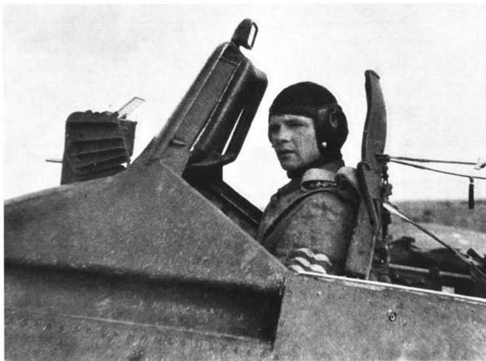
Hptm. Rudolf-Heinz Ruffer – as jednostek szturmowych, dowódca 10.(Pz)/SG 9 w kabinie Hs 129B-2. Dobrze widoczne szczegóły celownika Revi 12C, konstrukcja wiatrochronu i fotela pilota [Der Adler]
