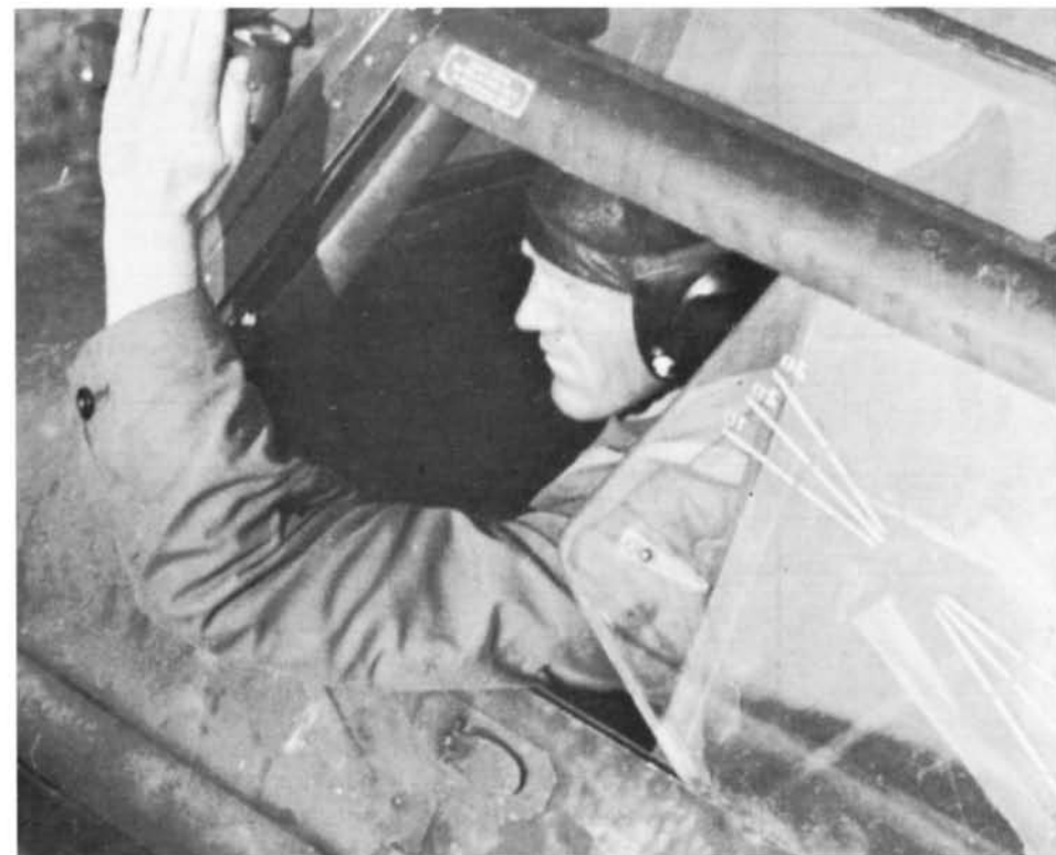
Kabina pilota samolotu Hs 129B-1, widoczna odsunięta szyby boczna kabiny, na szybie namalowane linie umożliwiające łatwe ustalenie kąta nurkowania samolotu [NTM].
